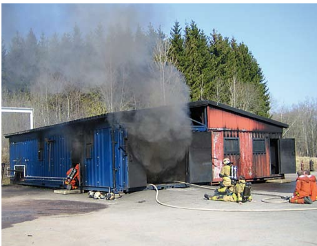
Der Übungscontainer des Typs »Garage« (Außenansicht im linken Bild) kann sowohl mit Holz als auch mit Flüssiggas – wie hier im rechten Bild zu sehen – betrieben werden.
