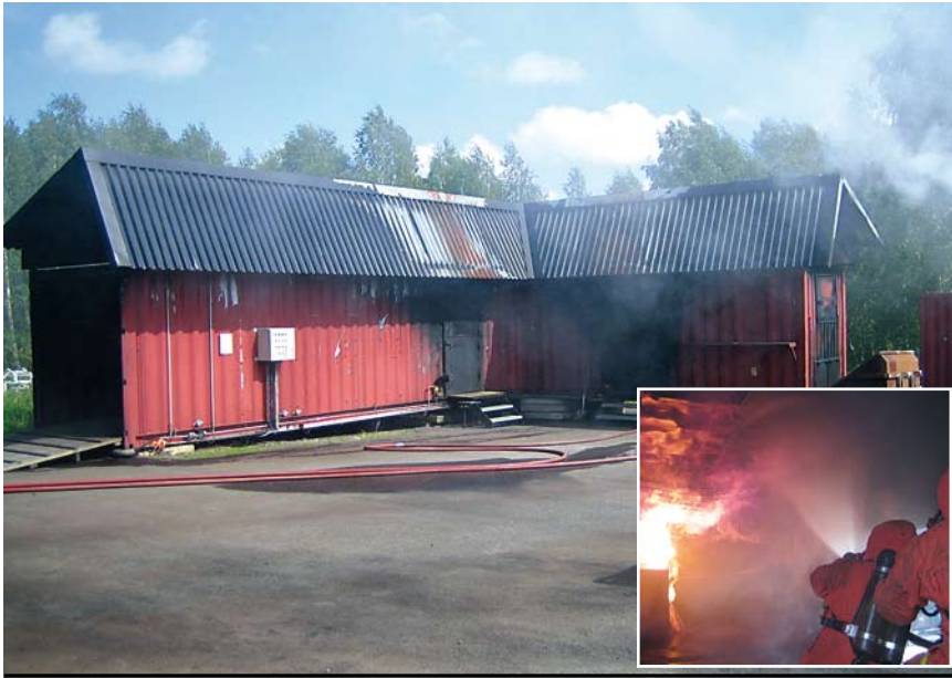
Im »Winkelcontainer« wird das Vorgehen eines Atemschutztrupps zur Brandbekämpfung geübt. Der Zugang erfolgt durch den 40-Fuß-Container, wobei der Trupp bei Durchzündungen immer wieder den Deckenbereich ablöschen muss (kleines Bild). Am Ende des Containers befindet sich eine Tür zum im 90-Grad-Winkel anschließenden 20-Fuß-Container, in dem ein Vollbrand bekämpft werden muss.
